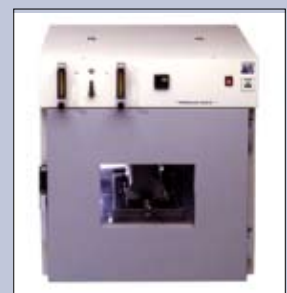
Ensayo de Envejecimiento con Cilindro Rotativo (©BRRC)
